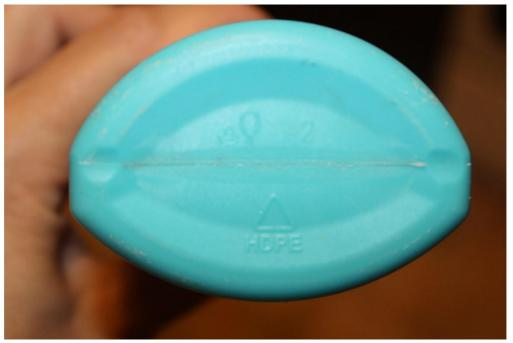
Пластик с такой пометкой — это полиэтилен высокой плотности, его возможно расплавить при температуре до 180 градусов, без выделения опасных для здоровья веществ, и избежать его возгорания при такой температуре.
